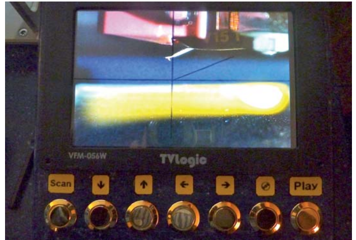
Kontrollmöglichkeiten in ungekannter Dimension: Nadelzustand und -position werden per Mikrokamera und Lasertechnik überwacht
