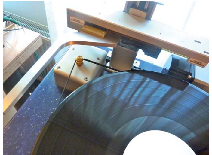
Titelanwahl komfortabel wie bei der CD: Ein separater Laser scannt die Plattenseite ab
